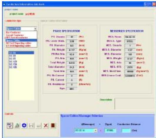
شكل (۸) - چند تمونه از منوهای نرم افزار محاسبات مکانیکی کشش و فلش خطوط هوایی کابل فاصله دار
