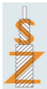
شکل ۳- علائم اختصاری نمایش جهت پیچش لایه
