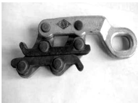
شکل ۱۷- گیره قورباغه‌ای مخصوص کشیدن سیم نگهدارنده
