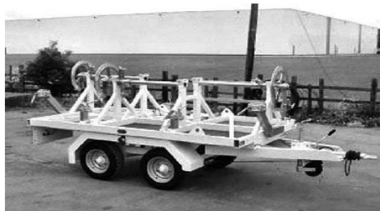
شکل ۷- ارباه حمل و باز کردن دارای سه محل قرقره برای سه فاز
